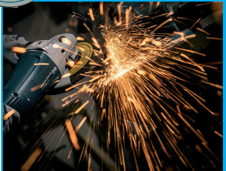
Le mole abrasive sono utensili di particolare efficacia per operazioni di taglio e di sbavatura. La gamma TAF, al fine di soddisfare le più svariate esigenze di utilizzo, si divide in due serie:
