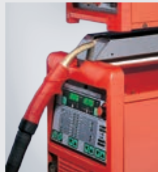
/ Supporto bruciatore integrato nel carrello “Pick-up”.
