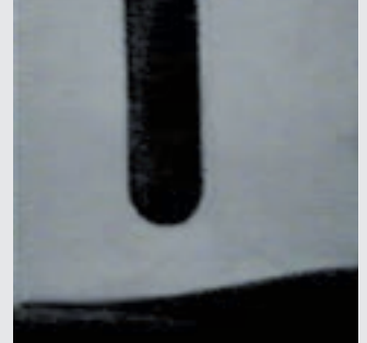
/ Fonte d'energia elettrica digitale: fine saldatura con impulso a scintillio.
