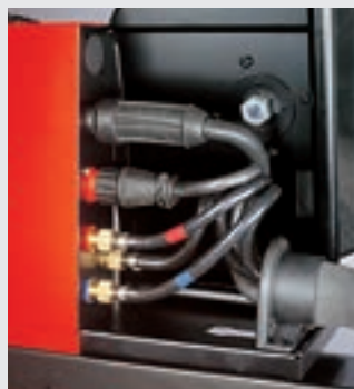
/ Lo scarico trazione per pacchi tubi flessibili di collegamento fa aumentare durata utile.
