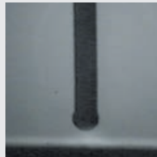
/ Direzione di trasporto fune indietro: accensione arco voltaico pilota
